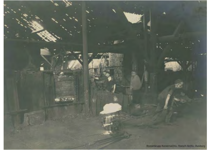
Arbeit der Puddler (Quelle: thyssenkrupp Konzernarchiv, Hoesch-Archiv, Duisburg) links das „Zängen, rechts der Abtransport per Schubkarre
